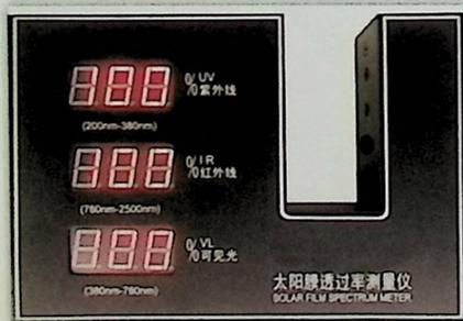
型玻璃红外紫外透光率测试仪
