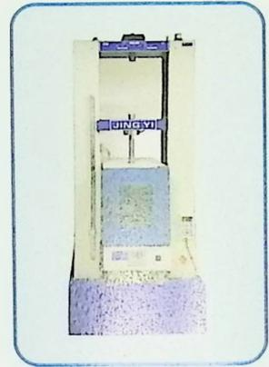
电子拉力试验机
