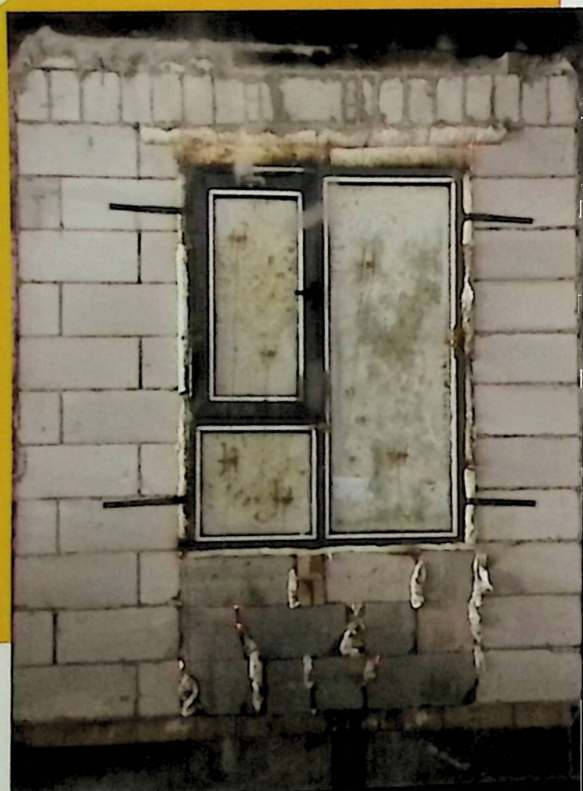
乙级防火窗检测烧检结束背火面实拍
