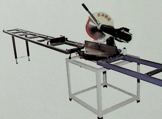
JLX-305 精密转盘切割机 Precision Cutting Machine
