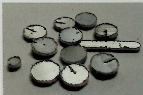
一般的激光切割挂渣效果
