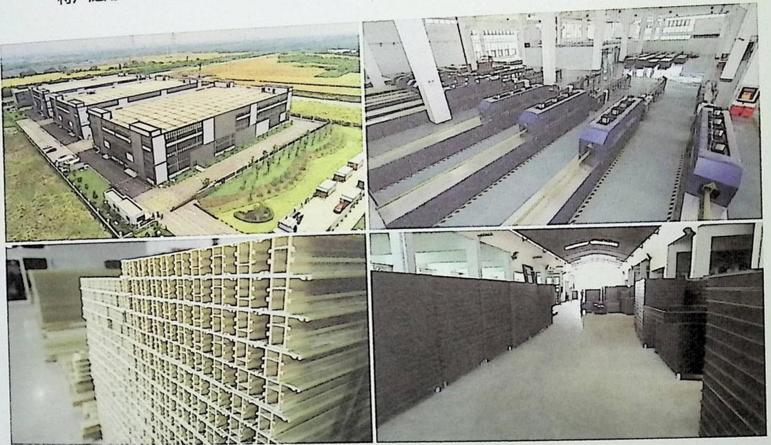
集韧凭借自身专业技术，自主研发了适用于聚氨酯复合材料复杂截面拉挤的注射盒、模具等一系列的设计、生产工艺，同时配合与亨斯迈集团共同研发的定制化拉挤用聚氨酯树脂，目前集韧的玻纤增强聚氨酯型材拉挤工艺能够实现长时间稳定生产，合格率达到95%以上，在世界范围内跻身于同行业先进水平。包括韩国LG等一众国际企业正在基于集韧现有设计、生产技术进行深度的交流与合作，以期能将此产品和相关技术引入本国市场。
