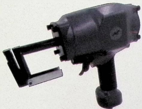
在不更换模具的情况下，直接打欧标槽，偏心槽的孔。把靠尺按下去，可打K槽的孔。可根据不同工厂，不同尺寸的铝型材定制模具。气压保证在6.3kg，可打实厚2.5mm以下的铝型材的孔。
