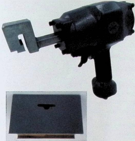
可根据不同工厂不同尺寸的型材定制各种蝴蝶形、长方形、椭圆形打孔器。
