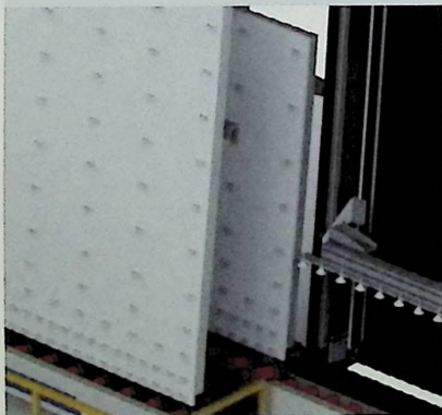
前后板传送系统 (涂胶过程中后板可传送玻璃) Double F/B conveyor System
