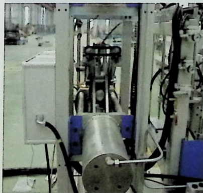
大容量比例泵（满足大板玻璃一次供胶） Bigger proportioning pump
