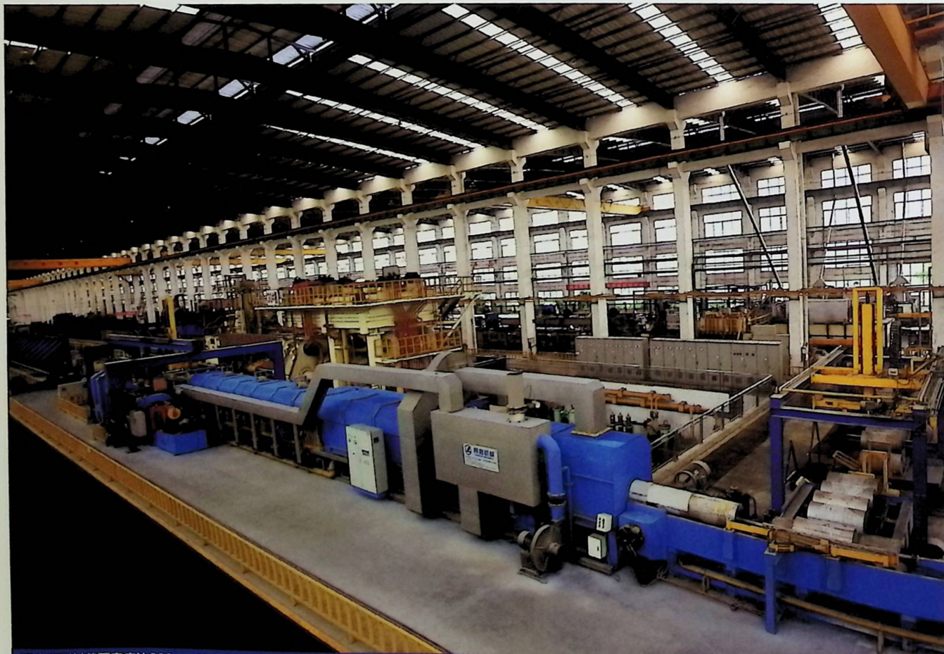
可生产型材截面宽度达800mm的10000T挤压生产线 The 800mm/10,000T capacity extrusion production lines
