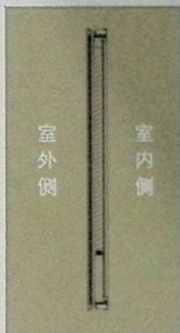
6高透在线Low-E+20Ar暖边+6(mm)
