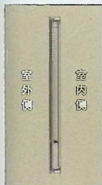
5高透离线Low-E+20Ar暖边+5四周暖边条(mm)
